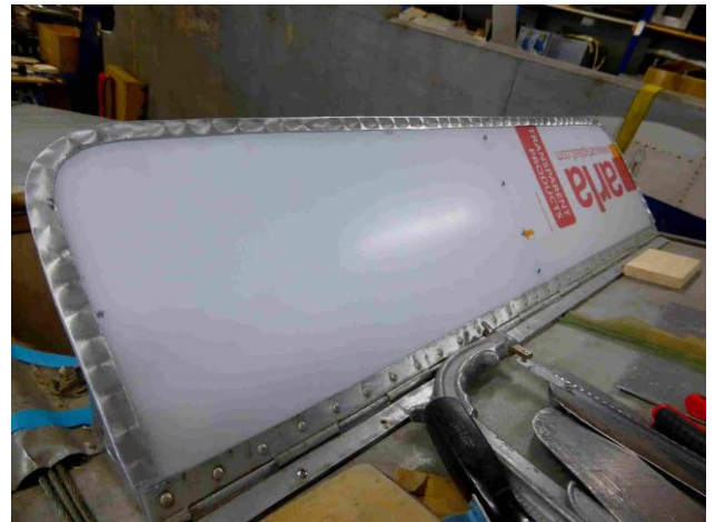
Valmis tuulilasi paikoillaan, mutta pleksin suojamuovi on vielä poistamatta.
