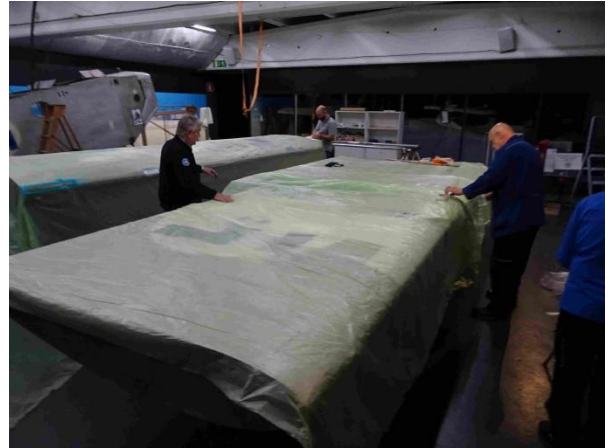
Maalattavaa siipeä peitetään suojamuovilla
