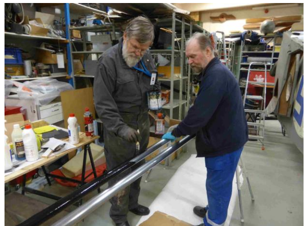
Siipitukein runkoputkia puhdistetaan rasvasta
