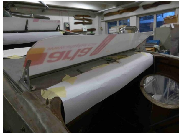
Polykarbonaattipleksit paikoillaan tuulilasissa
