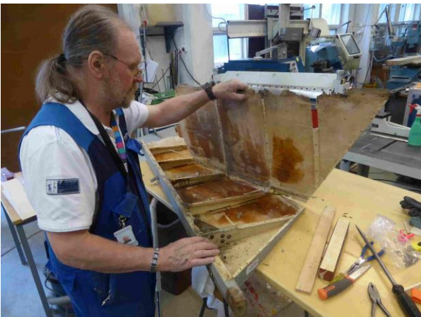
Peräsimen lahonnutta vaneripintaa irrotetaan
