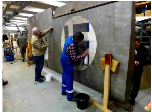
Siiven pintojen ihmesienipesu käynnissä
