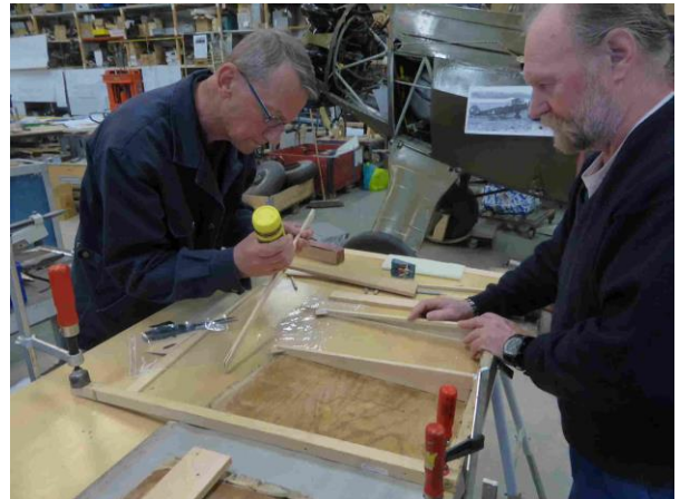
Korkeusperäsimen kärkeä rakennetaan
