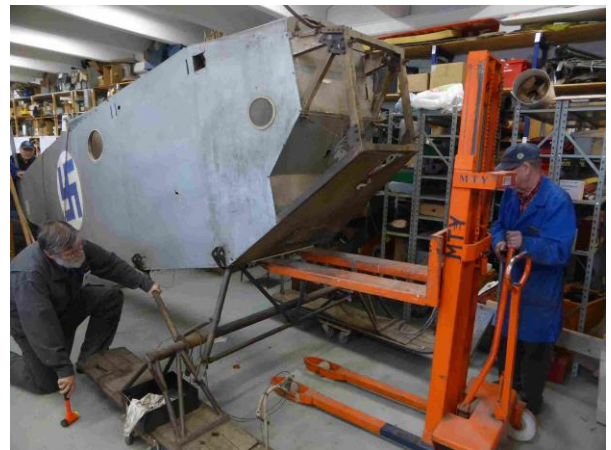
Telineettä irrotetaan Kurjen rungosta
