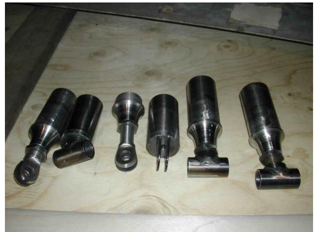
Uustuotantona tehtyjä siipitukien päiden holkkimaisia ja korvakemaisia kiinnikkeitä.
