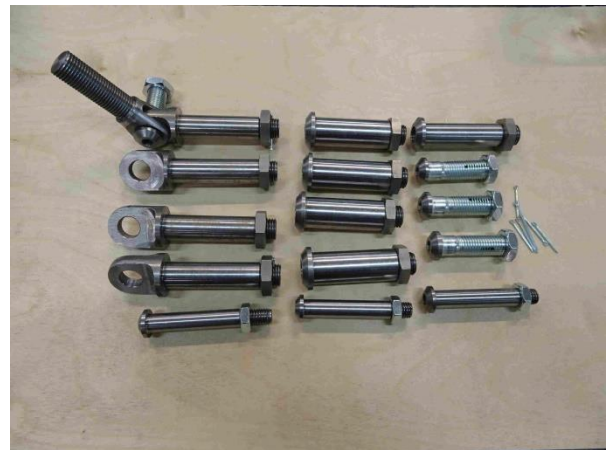
Valmistetut siipitukien, siiven ja laskutelineen lukitustapit.
