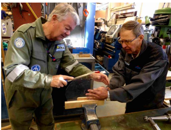
Polykarbonaatti-ikkunan reunoja hiotaan.
