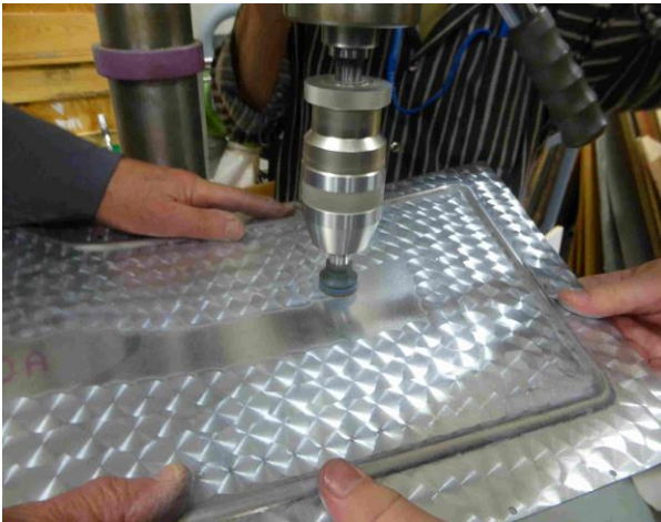
Pyöröhiontakuvouden tekeminen käynnissä
