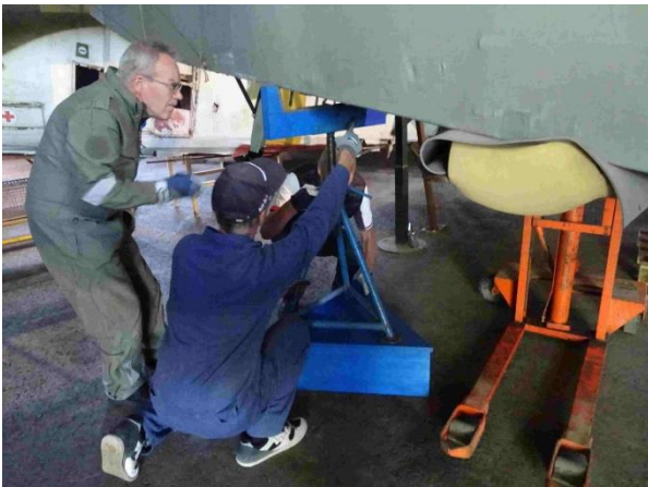
Metallista kolmijalkaa asennetaan uuden korokkeen päälle
