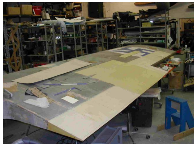
Osin uudelleen verhoiltu oikea siipi
