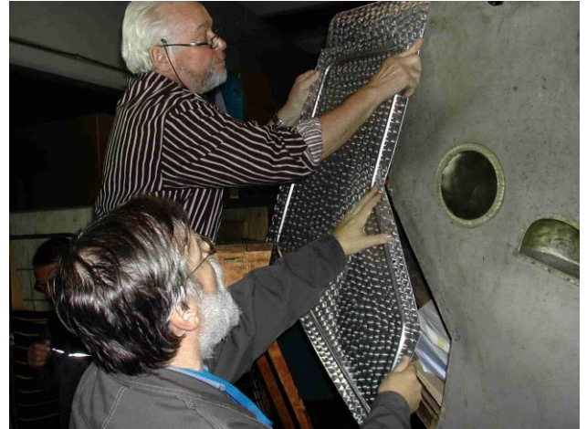
Uutta moottoripukin sivupeltiä asennetaan paikalleen
