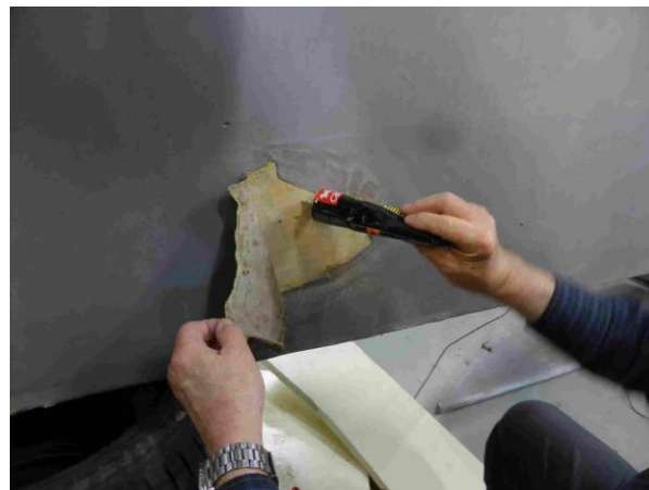
Repeämän palkeenkieltä liimataan
