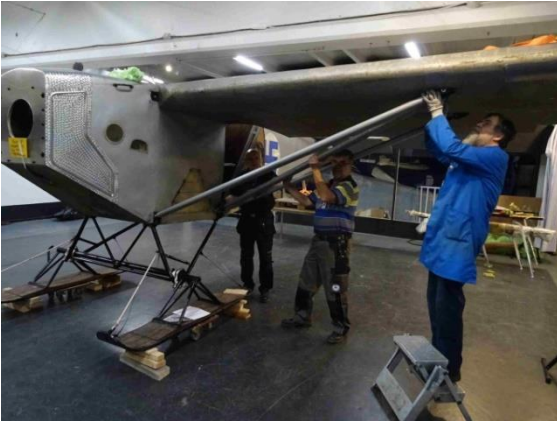
Siiven etutukea asennetaan vasempaan siipeen
