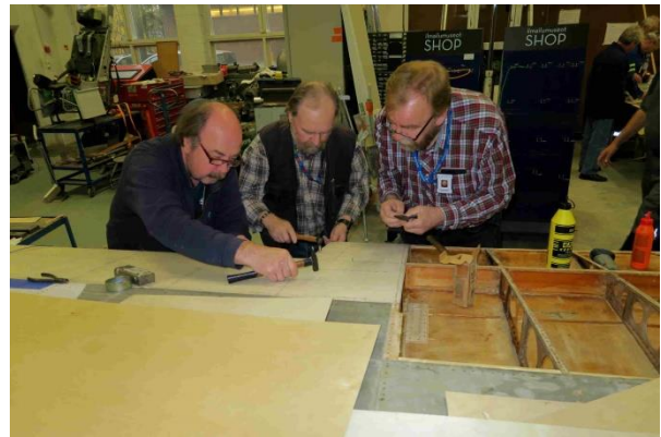
Siipeä vaneroidaan 1,2 mm vanerilla
