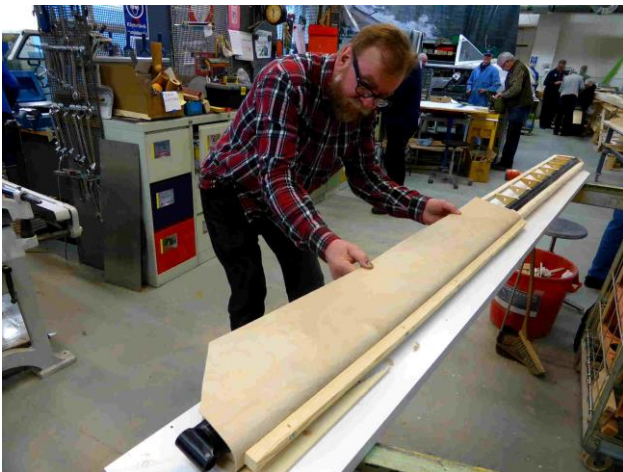
Siipituen toisen pään vanerikourua asennetaan siipitukeen
