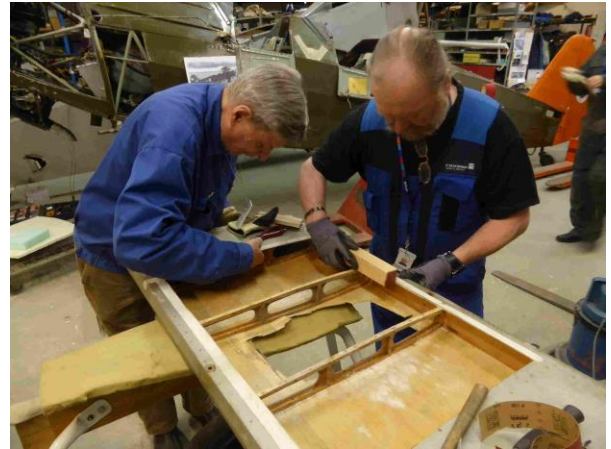
Vakaajan sisärakennetta korjataan
