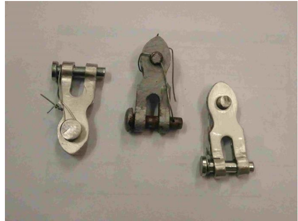
Keskellä alkuperäinen ja sivuilla uudet vaijerien liitoskappaleet
