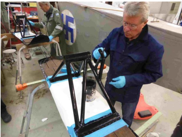
Suksen metalliosan maalaus käynnissä
