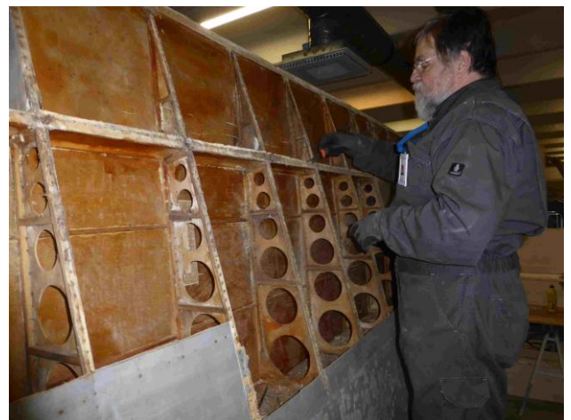
Siiven lahoa vaneriverhoilua puretaan
