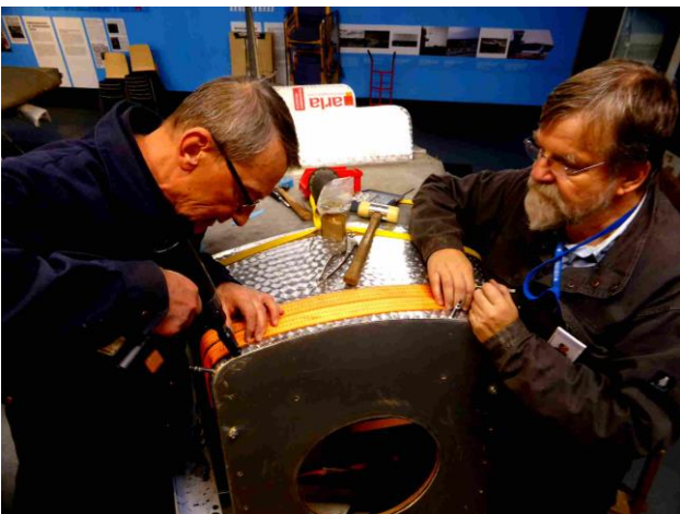
Moottoripukin uutta yläosan suojuspeltiä kiinnitetään paikalleen
