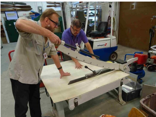
Vanerivuodasta leikataan sopivankokoisia kappaleita siiven verhoilemiseksi
