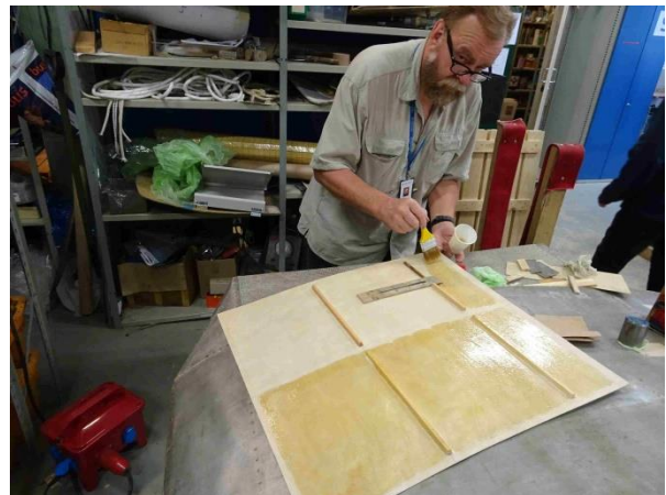
Verhoiluvanerin sisäpinnan suojalakattiin kosteutta vastaan.
