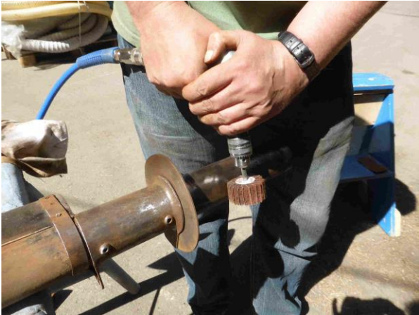
Ruosteen poistamista hiomalaikalla
