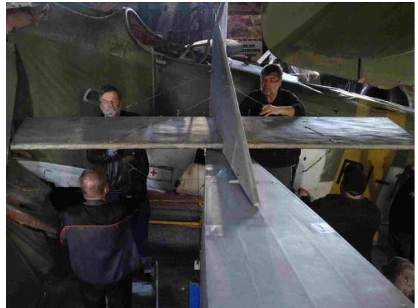
Kurjen pyrstöä kootaan Vesivehmaalla
