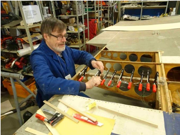
Siiven sisärakenteita korjataan
