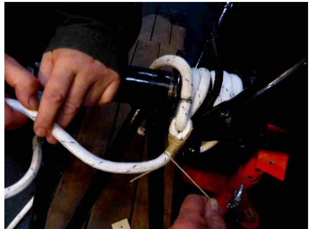
Purjehdusköyttä asennetaan sandumköyden sijasta laskutelineeseen
