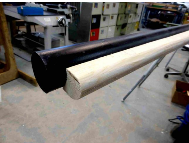
Keskituen johtoreunalista kiinnitettynä teräsputkisalkoon
