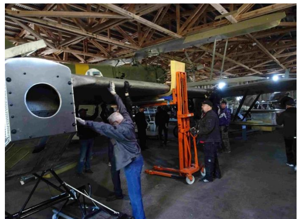
Vasenta siipeä asennetaan paikoilleen
