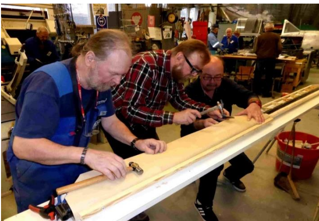
Vaneriverin liimaus varmistetaan nauloilla
