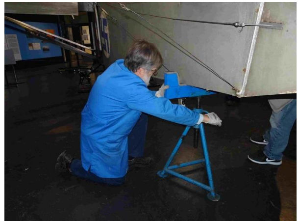
Kolmiotukea asennetaan Välihallissa Kurjen pyrstön alle
