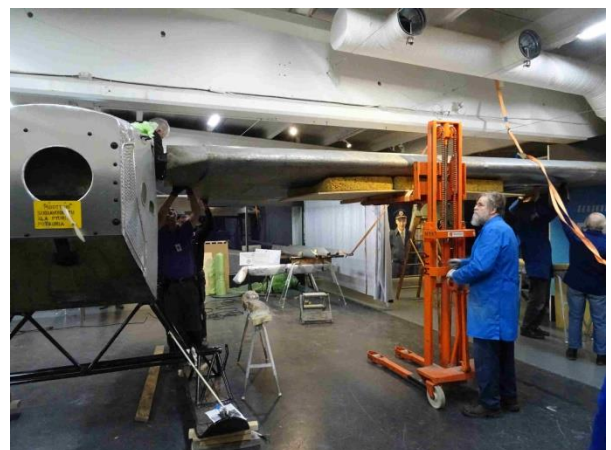
Siipeä nostetaan asennuskorkeuteen pinoajalla
