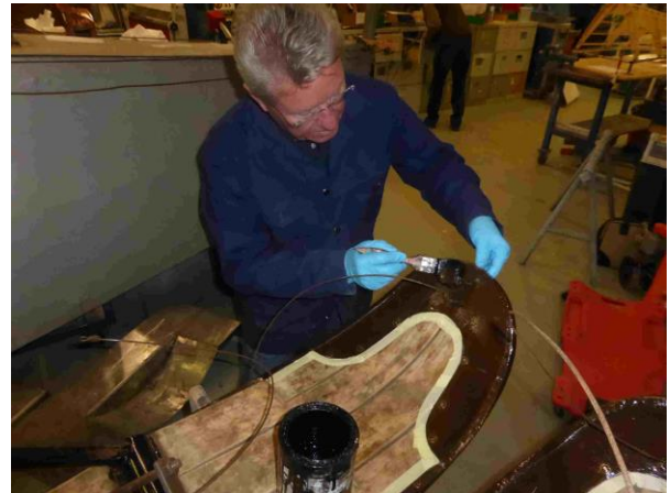
Lakkaa sivellään suksen metallikärkiin
