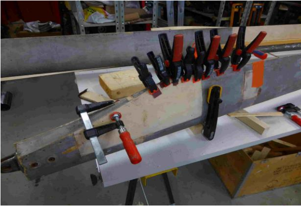
Alkuperäisen keskituen vaurioitunut pää uudelleen verhoiltuna
