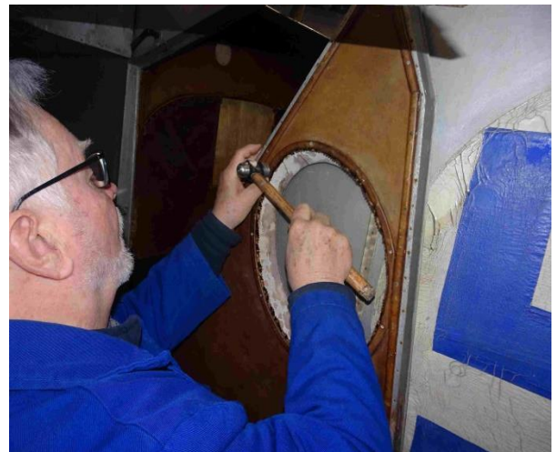
Ikkunan kehystä kiinnitetään paikoilleen
