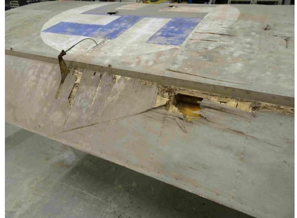
Siivessä olevia lahovaurioita
