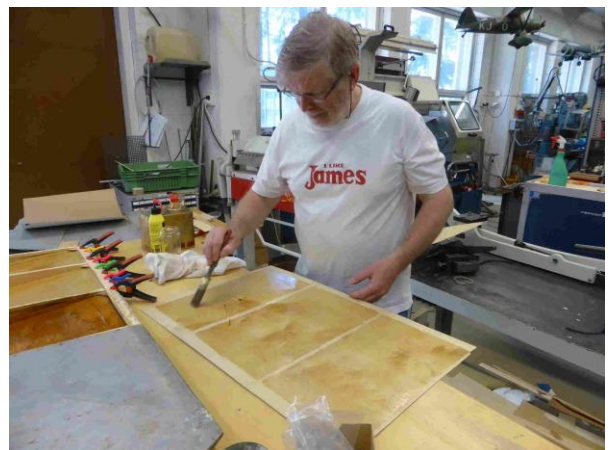
Vanerin sisäpinnan suojalakkaus käynnissä
