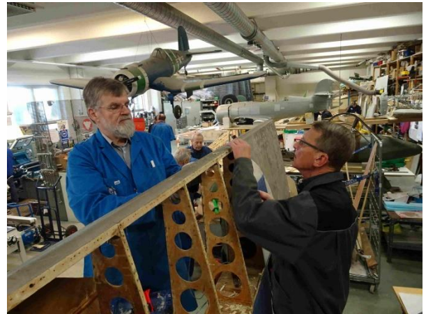
Siiven lahon vaneriverhoilun purku käynnissä
