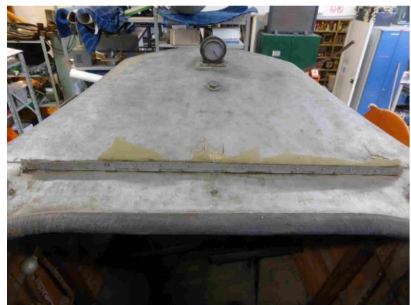
Tuulilasin kiinnityslista koneen pinnassa
