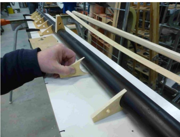
Keskituen johtoreunalista kiinnitettynä teräsputkisalkoon
