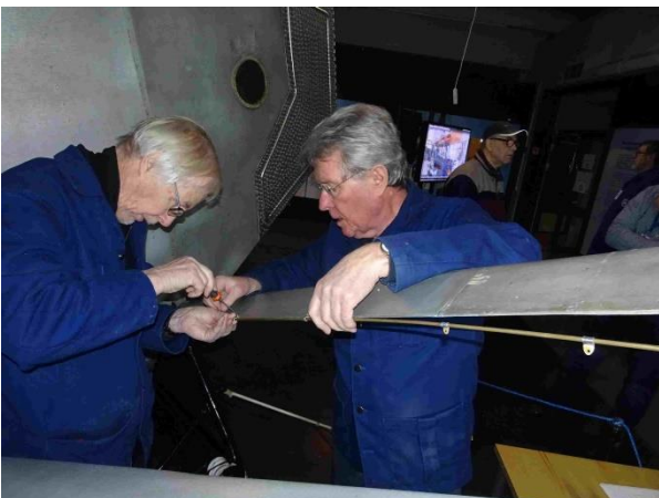
Venturiputken yhdysputkea kiinnitetään siipituen jättöreunaan.
